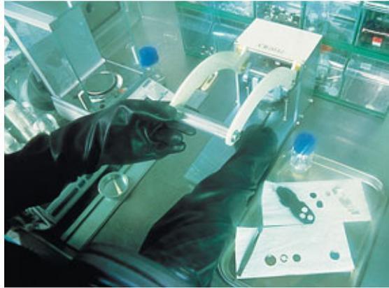
Montage d'un accumulateur au lithium en boîte à gants anhydre sous balayage d'argon au CEA/Grenoble.
